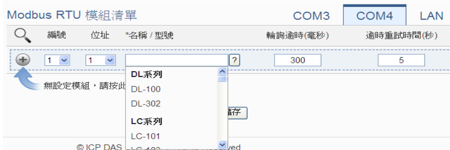
圖 6-28：Modbus RTU 模組名稱/型號設定
