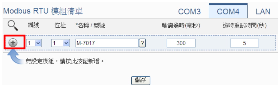
圖 6-29：新增 Modbus RTU 模組按鈕
