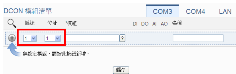
圖 6-13：I-7000/DL DCON 模組模組編號與位址設定
