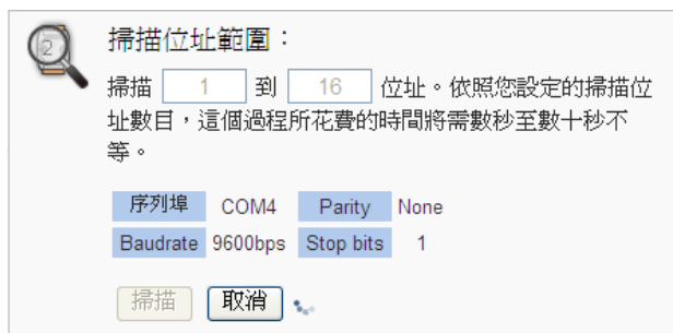
圖 6-24：泓格內建 Modbus RTU 模組掃描進行中
