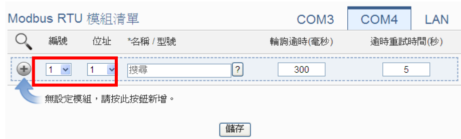
圖 6-27：Modbus RTU 模組編號與位址設定
