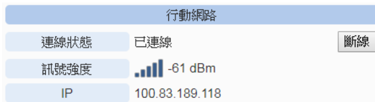
圖 5-5：行動網路 IP 位址與訊號強度顯示介面
