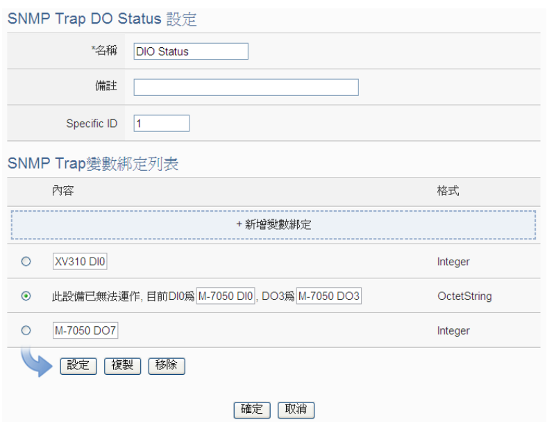
圖 9-30：SNMP Trap 參數設定頁面(包含“變數綁定”清單)
