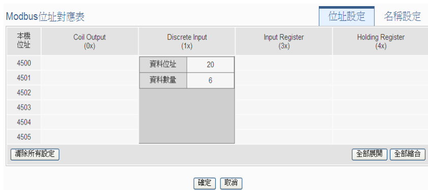
圖 6-38 : Modbus RTU 模組 Discrete Input 資料設定頁面範例
