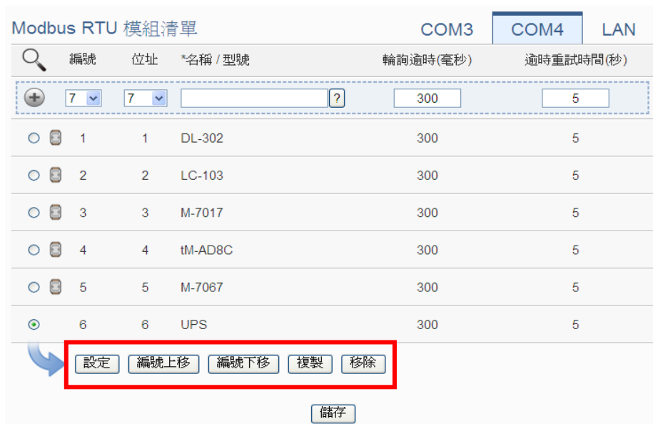
图 6-30: Modbus RTU 模块列表操作页面
