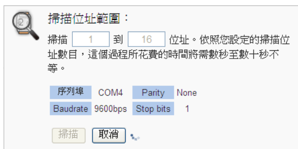
图 6-24: 泓格内建 Modbus RTU 模块扫描进行中
