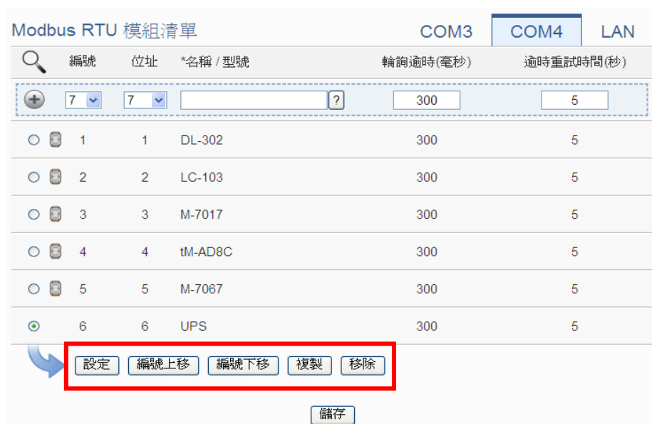
圖 6-30：Modbus RTU 模組清單操作頁面
