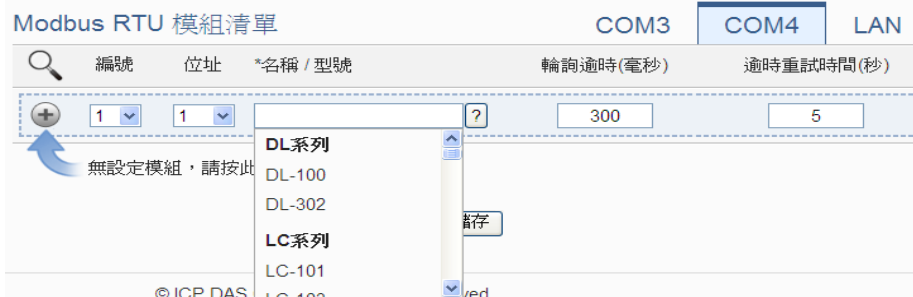
圖 6-28：Modbus RTU 模組名稱/型號設定
