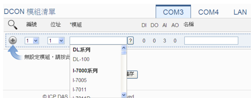
圖 6-14：I-7000/DL DCON 模組名稱/型號設定
