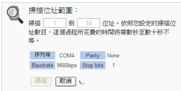
圖 6-24：泓格內建 Modbus RTU 模組掃描進行中
