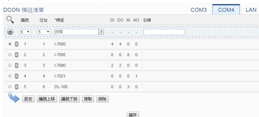
圖 6-11：I-7000/DL DCON 模組掃描結果清單
