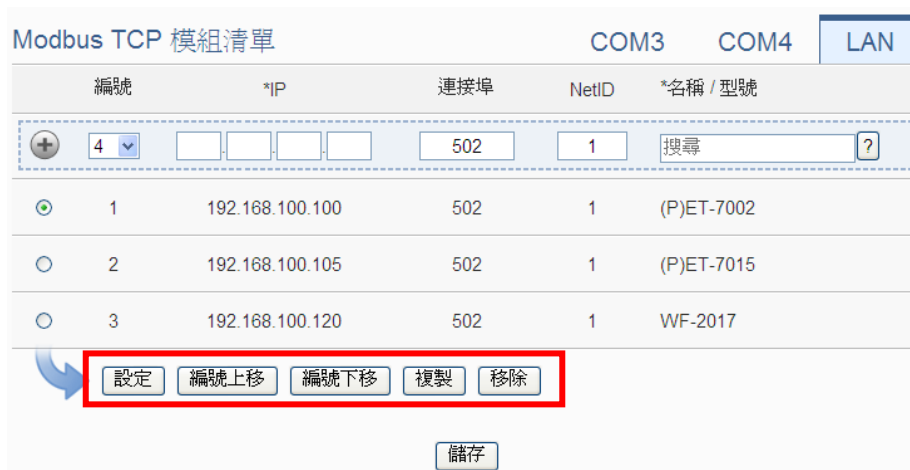
图 6-46: Modbus TCP 模块列表操作页面
