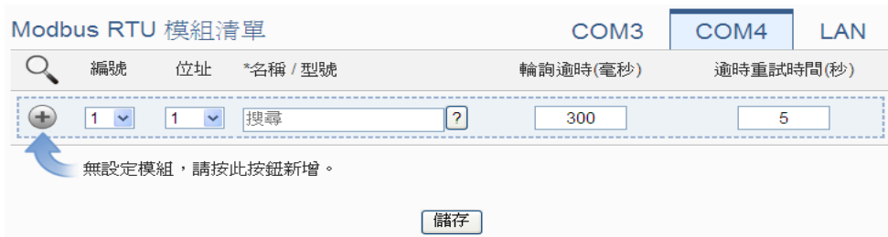
图 6-21：远程 Modbus RTU 模块设定页面
