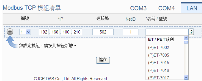
图 6-44: Modbus TCP 模块名称/型号设定
