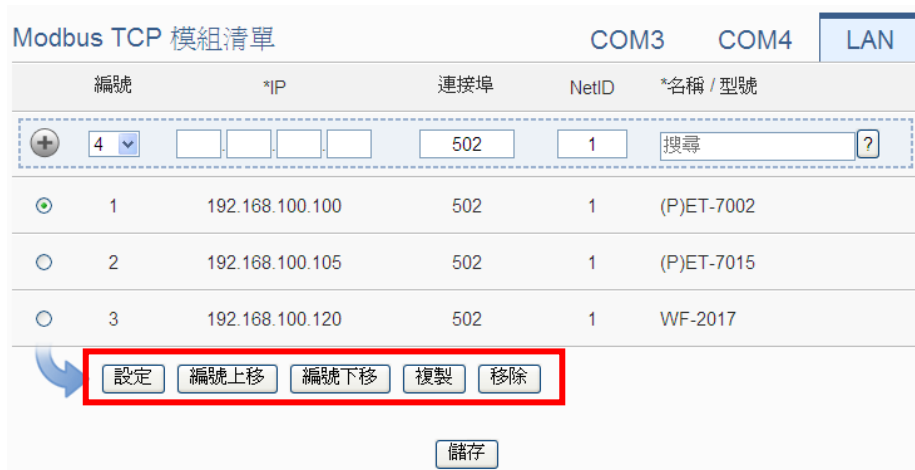
圖 6-46：Modbus TCP 模組清單操作頁面
