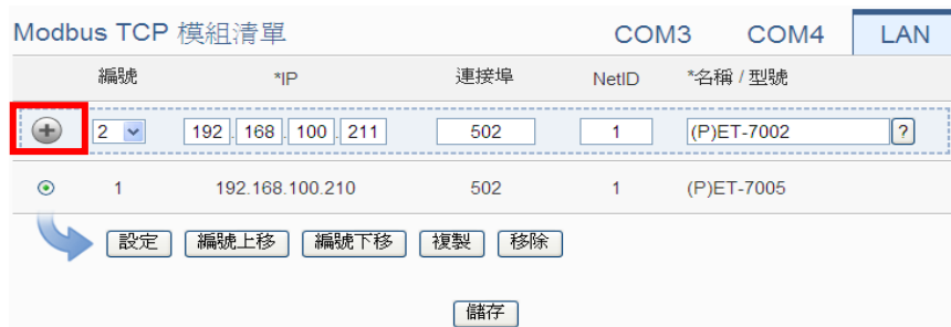
圖 6-45：新增 Modbus TCP 模組按鈕
