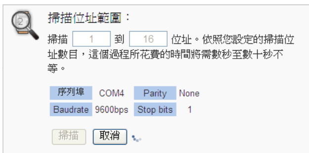
图 6-24: 泓格内建 Modbus RTU 模块扫描进行中
