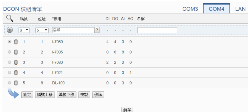
图 6-11: I-7000/DL DCON 模块扫描结果列表
