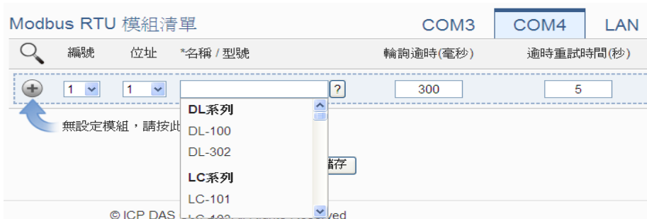
图 6-28: Modbus RTU 模块名称/型号设定
