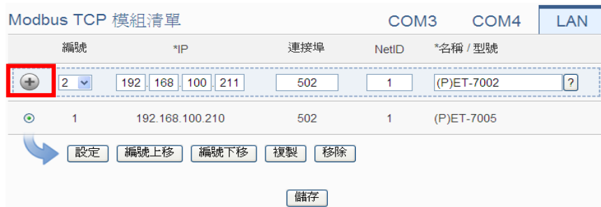
图 6-45: 新增 Modbus TCP 模块按钮
