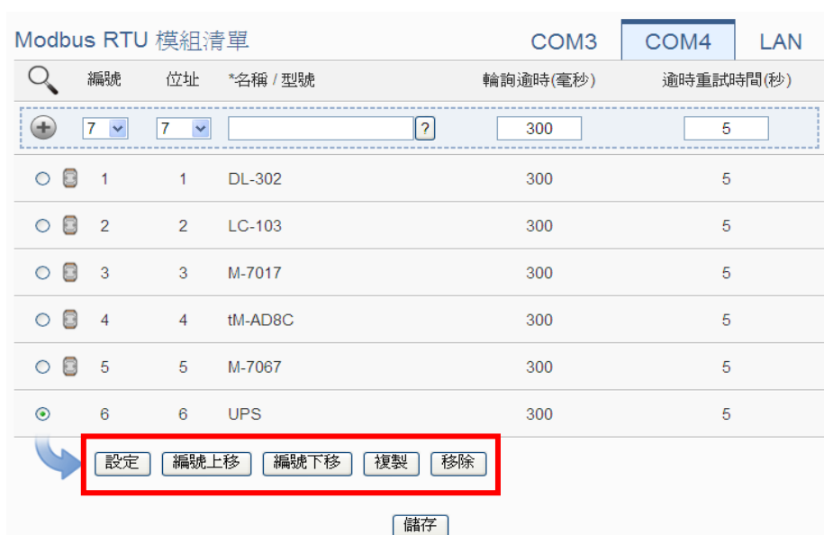
图 6-30: Modbus RTU 模块列表操作页面
