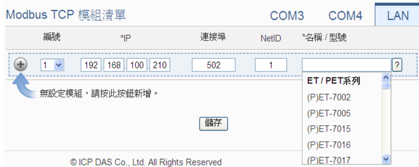
图 6-44: Modbus TCP 模块名称/型号设定
