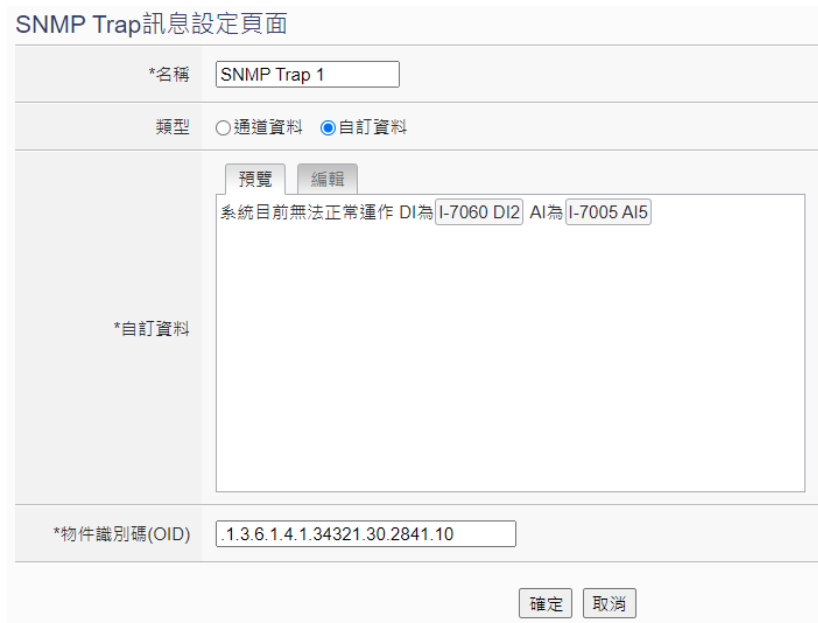
图 9-30: “预览”模式下的“自定义数据”类型设定页面
