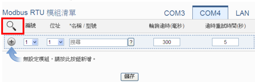
图 6-22：泓格内建 Modbus RTU 模块扫描功能按钮
